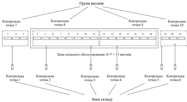
Рисунок 11 – Схема обслуговування вантажного фронту за моделлю «3 – 8 – 7 – 3»
